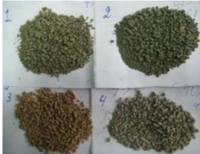
Resturi sedimentare din ind. vinicolă prelucrate cu : 1-cu sticlă solubilă; 2-bentonite; 3-carbonat de sodiu; 4-granule de argile diatomice și bentonite autohtone prelucrate.
